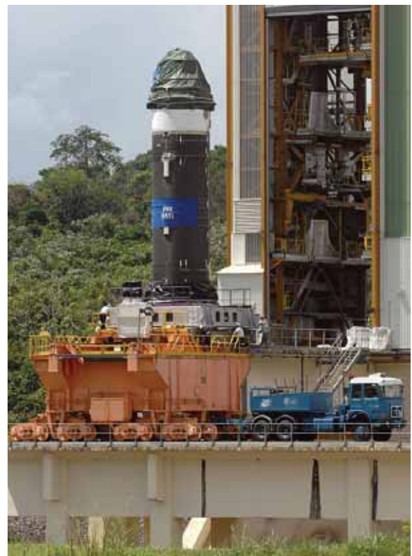
De P80-rakettrap op zijn transportplatform. © ESA
